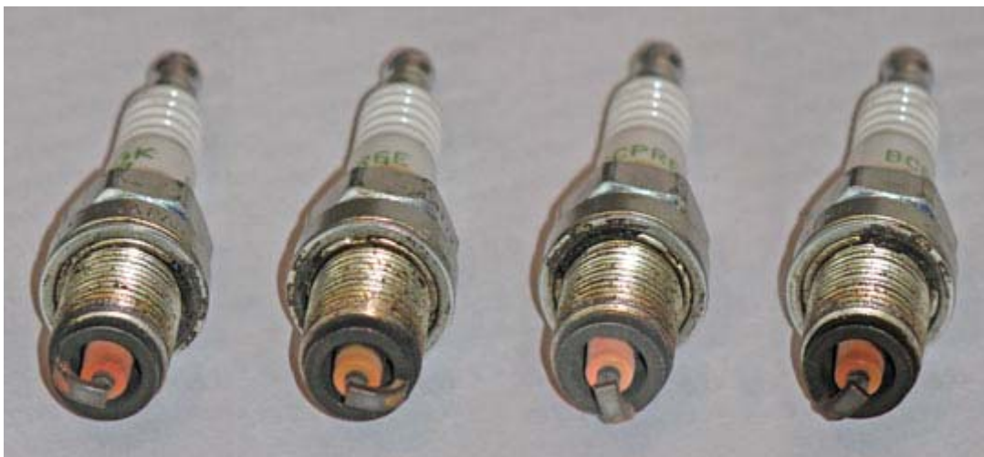
Разный цвет отложений на изоляторах свечей зажигания
