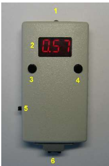
Рисунок 1: Индикатор толщины ИТ-01. Общий вид.
