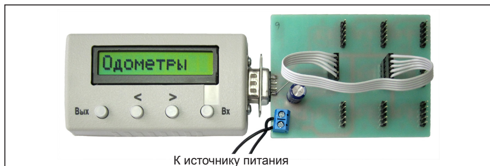
Рисунок 2. Подключение адаптера ПО5-EEPROM к программатору
