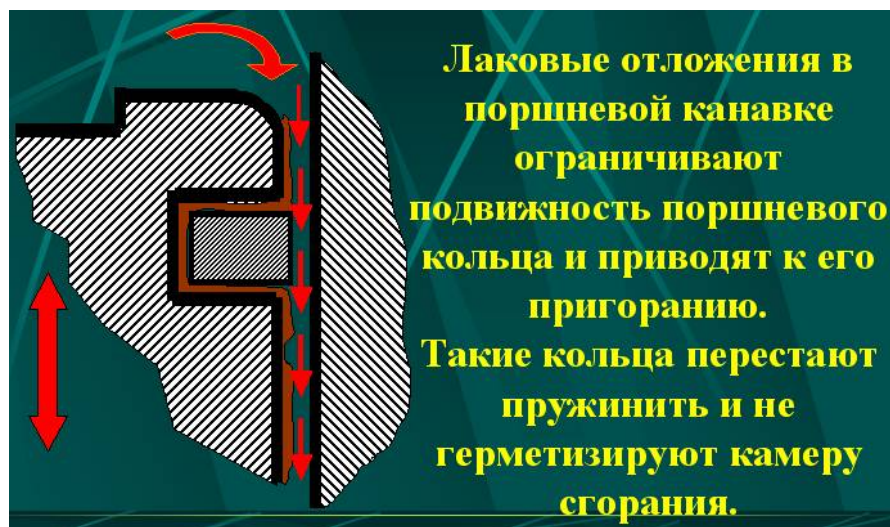
Рис 22. Потеря компрессии при пригорании поршневого кольца
